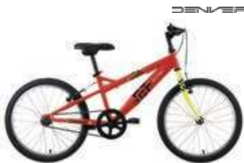
MOUNTAIN BIKE 20" MONOVELOCITÀ DENVER telaio in acciaio, versione ragazzo o ragazza, forcella rigida, freni V-brake in acciaio
